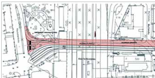
Työnaikaiset järjestelyt asematunnelissa.
