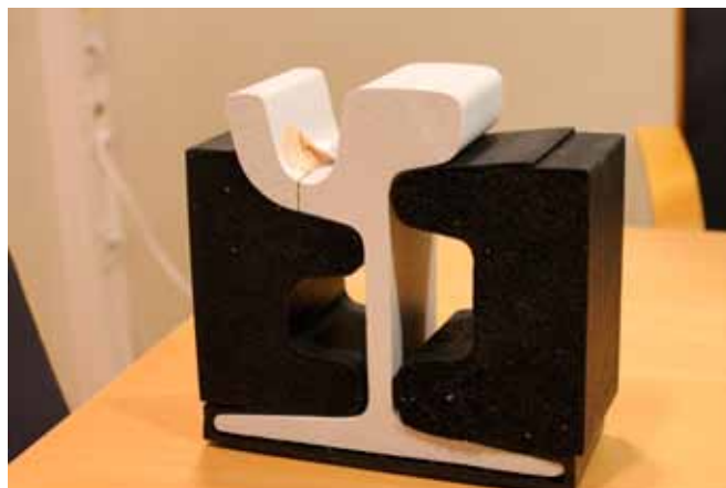
Urakiskon äänieristystä ja sähkövirtojen suojausmallia esiteltiin Big Roomissa.
