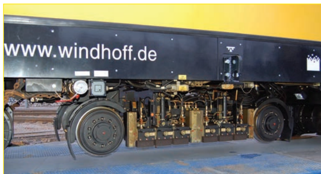
Hiomavaunun keskellä sijaitseva hiomateli. Kuva Jorma Rauhala.
