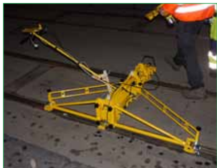
Työnnettävä mittaresiina, joka mittaa raiteen muotovirheitä, kuten raidelevyettä ja kierouutta. Kuva Antero Alku 9.11.2009.
