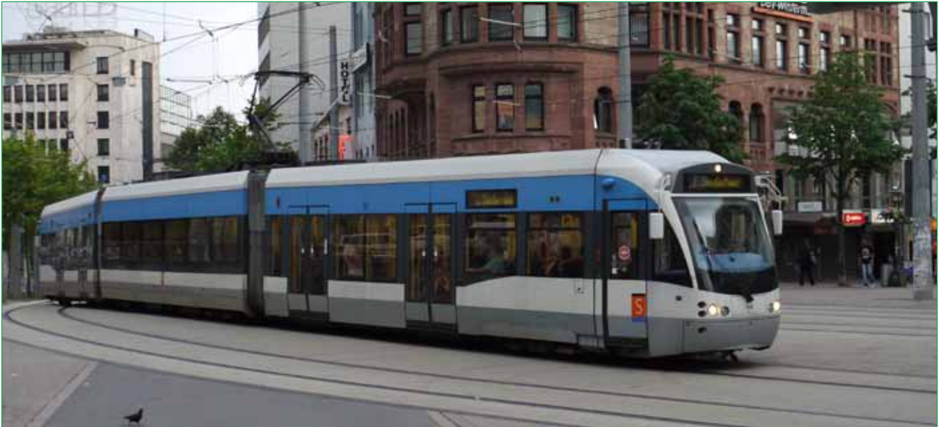
Saarbrückenin duoraitiovaunu, joka duovau- nuna kulkee sekä katuraitiotiellä että rauta- tievierkolla, muistuttaa perusrakenteeltaan Transtechin Helsinki-vaunua. Kuva Antero Alku 14.6.2010.
