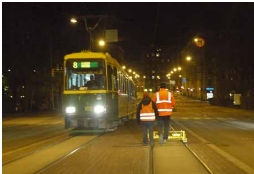
Työnnettävä mittaresiina, joka mittaa raiteen muotovirheitä, kuten raidelevyettä ja kierouutta. Kuva Antero Alku 9.11.2009.
