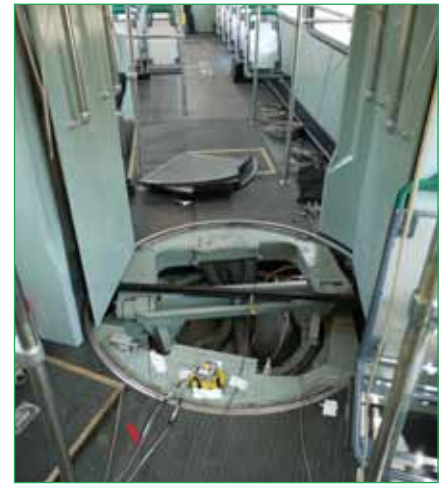
Raitteen vaikutusta vaunuun mitattiin useilla vaunun rakenteisiin asennetuilla antureilla. Mittausten aikana mittaus tietokone tallensi antureiden lukemat ja GPS:n avulla vaunun sijainnin sekä hetkellisen nopeuden. Kuvat Antero Alku 4.7.2009.
