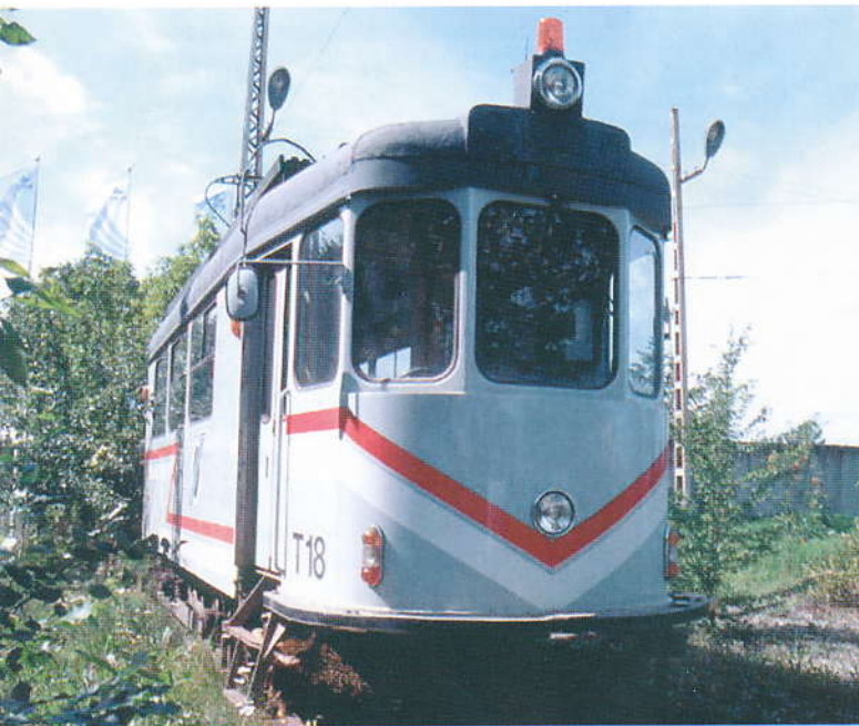
Tallinnalainen harja-vaunu T-18. Pyörivä lumiharja on sijoitettu huomaamattomasti vaunun etusillan alle. Vaunu on rakennettu tallinnalaisella Ilmarine-vaunutehtaalla vuonna 1951 (alkujaan nro 40) ja muutettu 1967 harjavaunuksi. Vuosien mittaan sitä on luonnollisesti kunnostettu ajantasaiseksi ja nykyään se vaikuttaa ainakin ulkoisesti helsinkiläisiä virkaveljiään nykyaikaisemmalta. Kuva Jorma Rauhala, Koplin varikko 7.8.2002.
