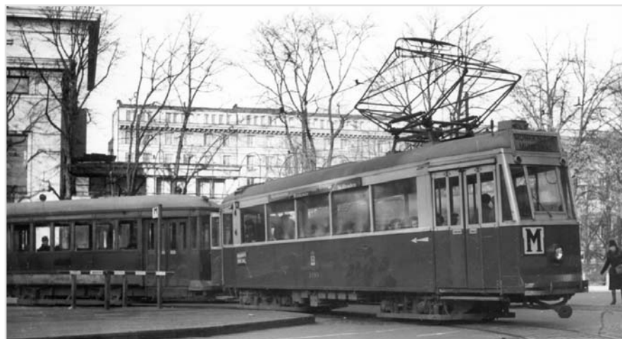
Vaunu 433 koeajolla Munkkiniemessä syksyllä 1941. Vaunun valonheittimessä on sodan aikana käytetty pimennyslevy. Kokoelma Jorma Rauhala.
