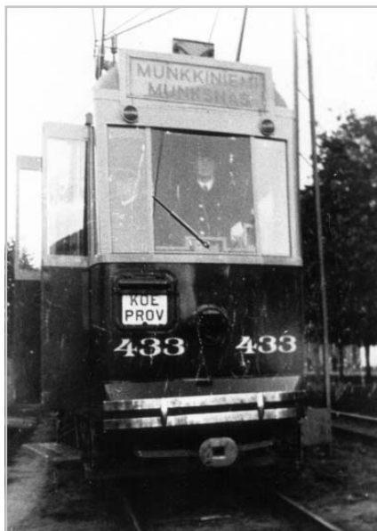
Vaunu 433 koeajolla Munkkiniemessä syksyllä 1941. Vaunun valonheittimessä on sodan aikana käytetty pimennyslevy. Kokoelma Jorma Rauhala.
