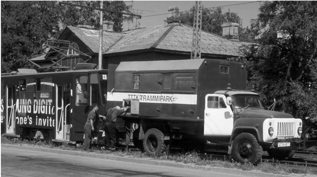
Linjan 2 vaunun nro 81 ensimmäinen pyöräpari suistui kiskoilta Segan ja Sirbin pysäkkien välillä 26.7.2001. Suistumisen aiheutti ilmeisesti radan huono kunto. Paikalle asetettiin tämän jälkeen nopeakasvatus 5 km/t. Kuva Sakari K Salo.
