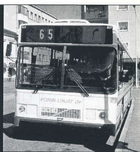
LUJARAKENTEISILLE VOLVO B10M –AUTOILLE HALUTTIIN JATKOAIKAA JA SEN JOHDOSTA AUTOJA ON ALETTU KORITTA A UUDELLEEN. TÄSSÄ AUTO 18 CARRUS K204 –KORISENA, ALKUPERÄINEN KORI OLI TAIVAL GL. KUVA JUHANA NORDLUND 25.4.1998
