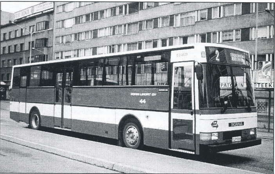
VUONNA 1987 SAATIIN KÄYTTÖÖN KOLMELLA OVIAUKOLLA VARUSTETTUA AUTOMAATIVAIHEISIA KAUPUNKIAUTOJA KESKUSTALINJOILLE. KUVASSA AUTO 44, SCANIA N112CL/AJOKKI EXPRESS. KUVA JUHANA NORDLUND 6.6.1987
