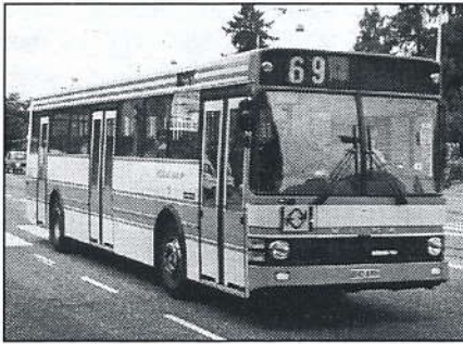
ENSIMMÄINEN KULMAVAIHDE-SCANIA METSÄLÄLLÄ, AUTO 5. KUVATTU HYVIN UUTENA 22.6.1988. IKKUNOIDEN YLÄPUOLISET RAIDAT OVAT MUISTA METSÄLÄN K202-WIIMOISTA POIKKEAVAT. KUVA JUHANI POUSSA.
