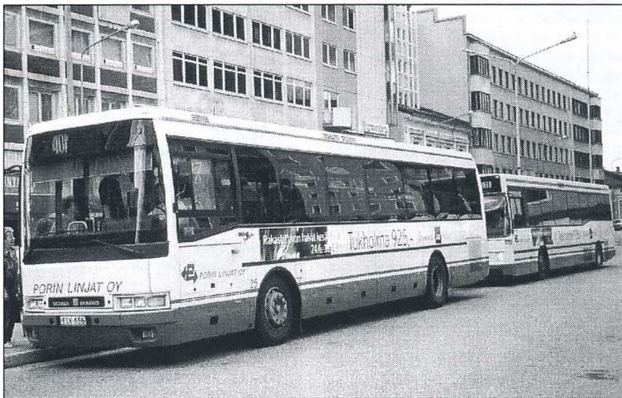
OSAAN VUOSINA 1982-83 VALMISTUNEISTA AUTOISTA (SCANIA K112CL) PÄÄTETTIIN MYÖS RAKENUTTA UUSI KORI. KORIT TEETETTIIN UNKARILAISILLA IKARUKSELLA. KORITYYPPI ON IKARUS E95. KUVASSA AUTO 25. TAKANA AUTO 22, JOKA MAALATTIIN UUDELLA KAAVALLA KOLARIKORJAUKSEN YHTEYDESSÄ. VERTAA HELMAN ALAOSAN VÄRIJAKOJA AUTOA 22 ESITTÄVÄÄN ERILLISEEN KUVAAN. KUVA JUHANA NORDLUND 1.7.1999
