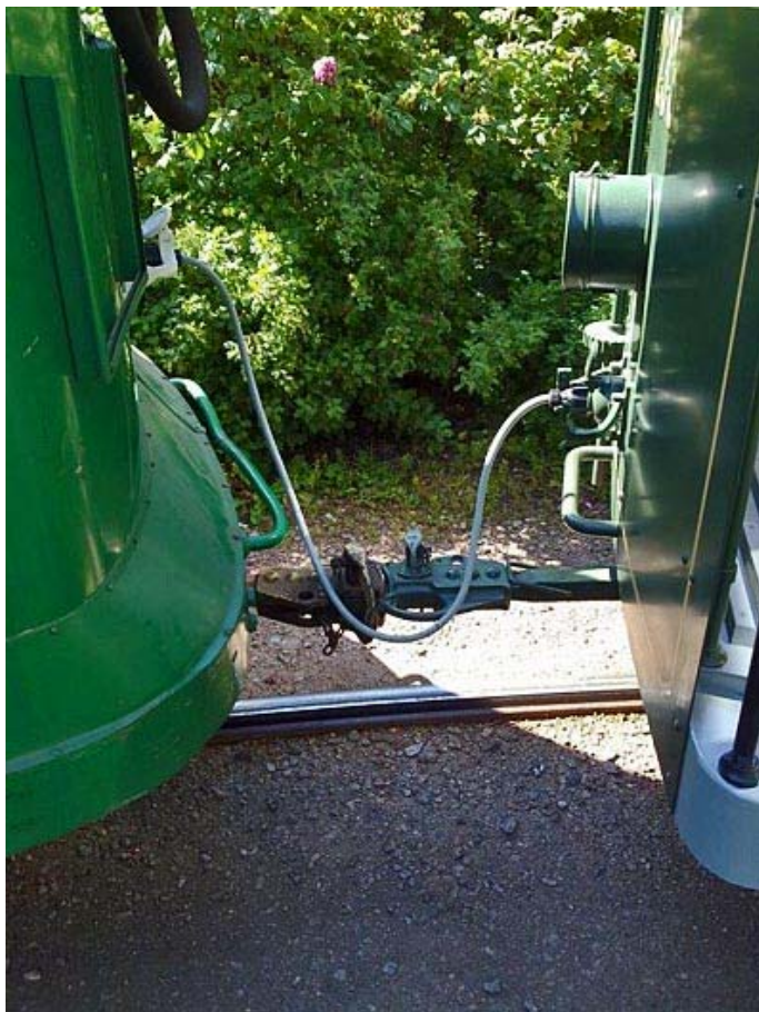
Kusiputkan kurviin mentiin tutkimaan kytkinten liikeratoja. Vaunu kurvissa. Kuvat © Markku Fredman:
