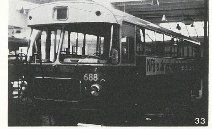
kuva 4: Mercedes-Benz LB 608 ovet 0-100-0 HKL not 56-59 hankintavuosi 1967 alusta: Mercedes-Benz AG, BRD kori: Autokori Oy, Lieto
