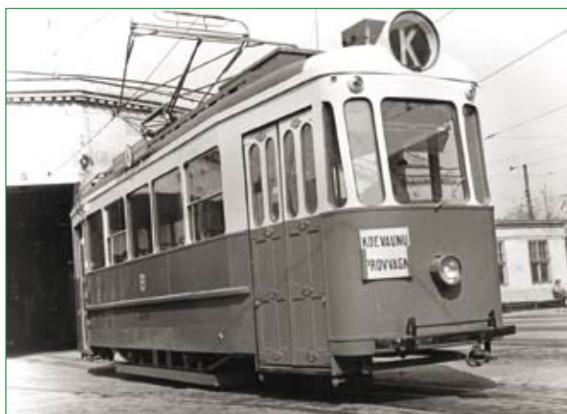
Ensimmäinen vaunu 219 Vallilan hallissa. Kori on kapea ja kyljissä on paksut kylkilistat. Helmapelti on vielä alhaalta suora, peittäen osittain alusrakennetta. Linjakilvitys on K-linjalle Käpylä–Kauppatori. Kuva 3.5.1950 Bertel Okkola.
