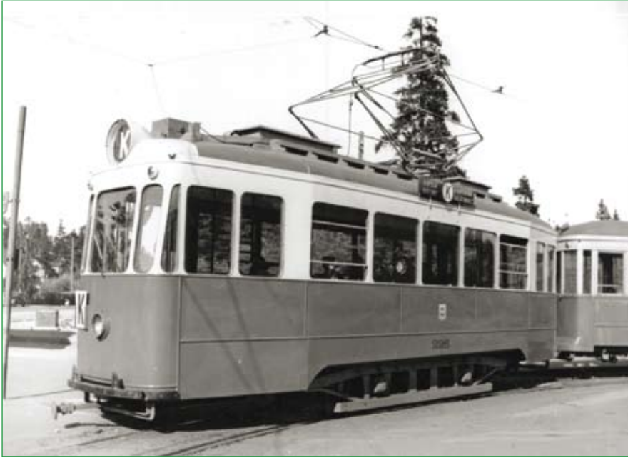
Vaunu 226 K-linjan Käpylän pääte pysäkillä. Auringon linjatunnus on peltiin aukileikattu K-tunnus. Yksimerkkistä linjatunnusta ei yleensä käytetty peltiin leikatussa "negatiiviversiossa", vaan se oli "positiiviversio" eli pelkkä linjatunnus. Kuva Jan Walter 10.6.1951.
