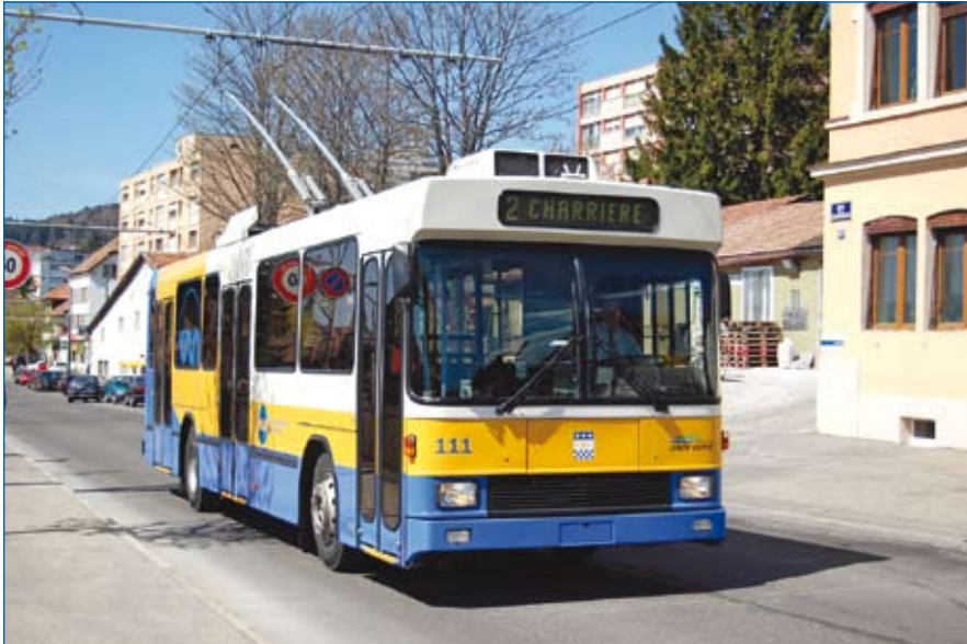
12. La Chaux-de-Fondsissa on yksi Sveitsin pienimmistä johdinautojärjestelmistä, vaikkakaan ei pienin. Vanhimmat käytössä olevat johdinautot ovat korkealattiaiset NAW / Hessit TRN 111 - 113. Ne ovat kaksiakselisia ja sen kokoisia trollikoita käytetään linjalla 2. Kuva Juhana Nordlund 29.4.2010.
