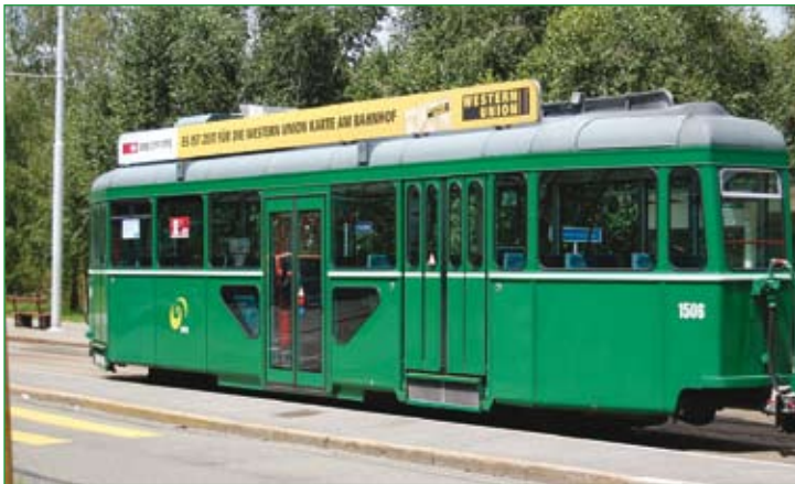
Perävaunu B4S BVB 1506. Vaunua on madallettu keskikohdastaan ja siihen on asennettu uudet ovet. 8.7.2009.
