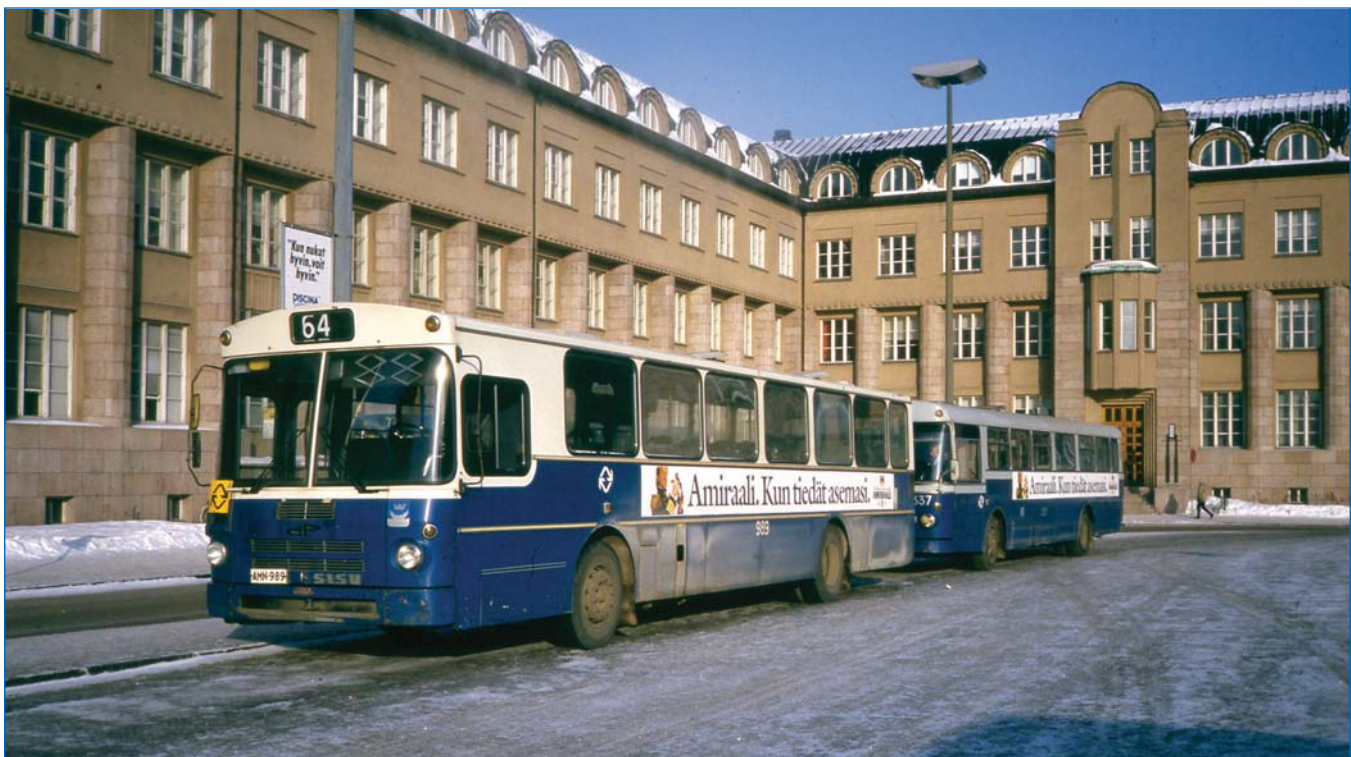
HKL 989, Sisu BT-71BVT / Delta 100 City, linjalla 64 Rautatientorilla. Auto 989 oli varustettu äänieristetyllä moottoritalalla sekä ilkivallan kestävillä istuimilla. Kuva Juhana Nordlund maaliskuulta 1987.
