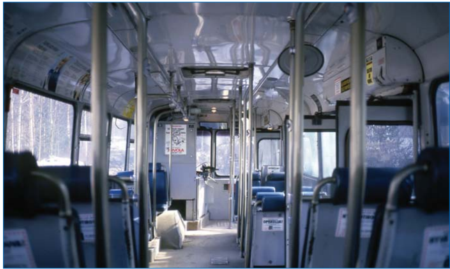
HKL 989, Sisu BT-71BVT / Delta 100 City, linjalla 64 Rautatientorilla. Auto 989 oli varustettu äänieristetyllä moottoritalalla sekä ilkivallan kestävillä istuimilla. Kuva Juhana Nordlund maaliskuulta 1987.
