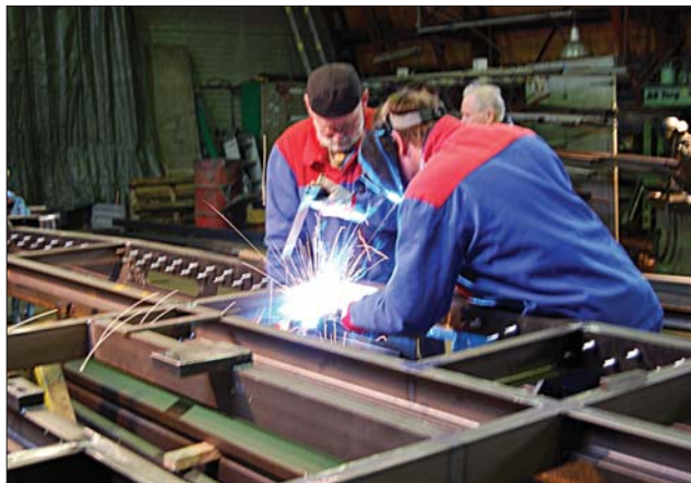
Vaunun alusta sekä päätyseinät lähes valmiina Tergin tiloissa 15.9.2008.
