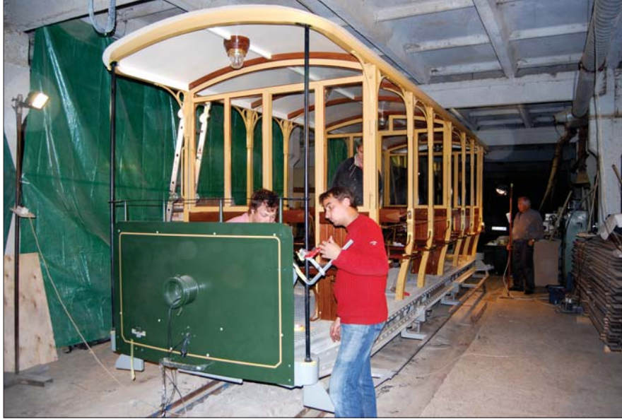
Viimeistelytyöt käynnissä Kiilissä 21.7.2009. Lopputarkastus tehtiin samana päivänä.
