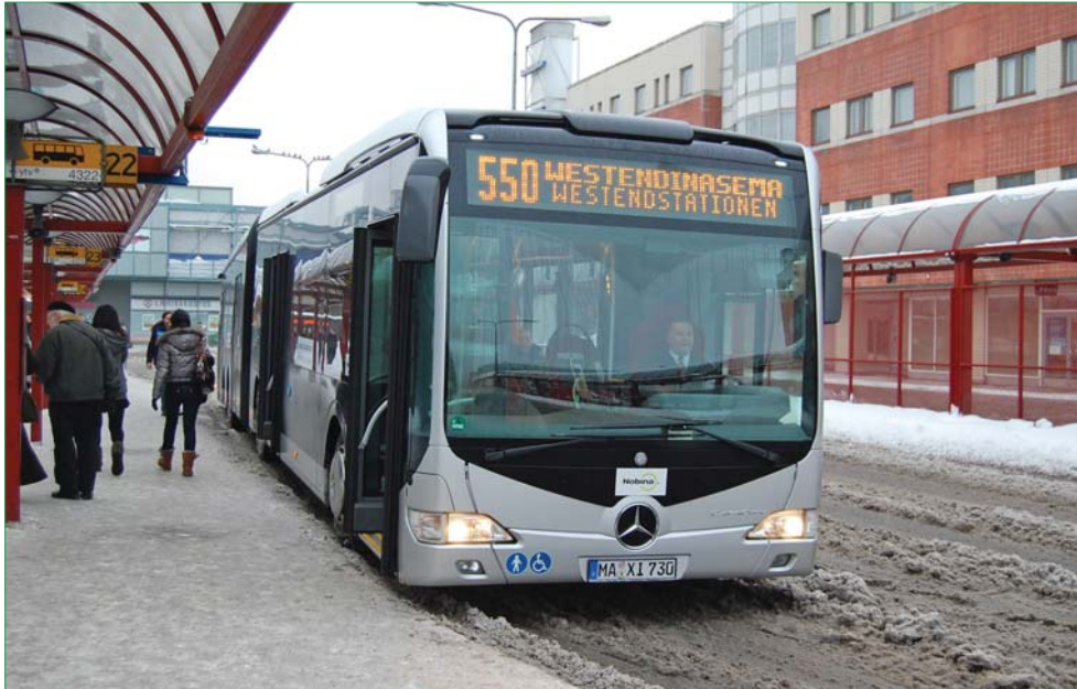
Nobina ja HSL kokeilivat Mercedes-Benz O530 GL CapaCity -nivellibussia 26.2. alkaen vajaan viikon ajan Jokeri-linjalla 550. Kokeilulla haluttiin selvittää mm., paljonko avorahastus ja mahdollisuus nousta autoon kaikista ovista nopeuttavat matkantekoa. CapaCityn pituus on 19,5 m. Kuva Juhana Nordlund 27.2.2010.
