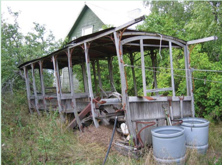
Vaunu 233 huvimajana Lohjalla 5.9.2006. Vaunu on päässyt jo huonoon kuntoon, mutta kaikki pienmetalliosat osoittautuivat käyttökelpoisiksi, samoin monet puuosat, kuten kuvassa näkyvät penkit, olisi voinut käyttää uudelleen.
