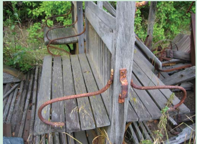
Vaunu 233 huvimajana Lohjalla 5.9.2006. Vaunu on päässyt jo huonoon kuntoon, mutta kaikki pienmetalliosat osoittautuivat käyttökelpoisiksi, samoin monet puuosat, kuten kuvassa näkyvät penkit, olisi voinut käyttää uudelleen.
