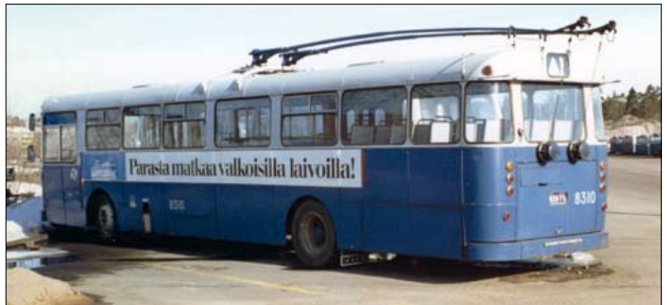
Johdinautojen ajojohtimien huurteenpoistotoksi muutettu HKL 8310 (ex 831) Ruskeasuolla. P. Leinomäki 27.3.1982.
