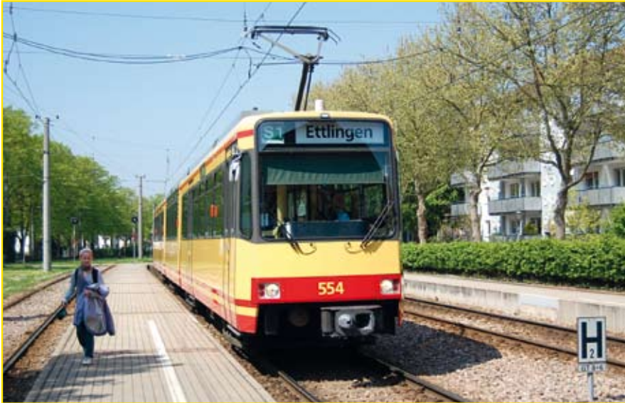
AlbtalBahn. Linjan S1 raitiovaunujuna saapuu Ettlingen Stadtin asemalle. Osa S1:n vuoroista kääntyy ympäri jo Ettlingenissä. Kalustona tässä vuorossa on Düwag GT8-80C VBK 554 (alkujaan 854) vuodelta 1989. Vaunujen 551 - 560 välisissä ei ole ovia lainkaan. Kuva Juhana Nordlund 20.4.2009.
