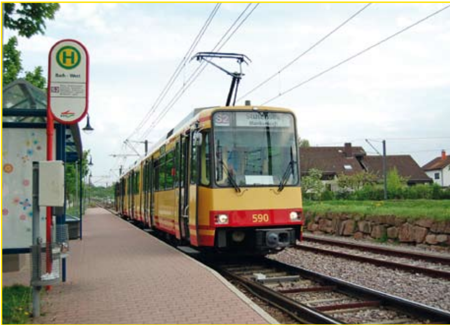
Rheinstetten. Tässä ollaan enää muutama kilometrin päässä Ranskan rajalta. Kuvassa Düwag GT8-80C VBK 590 vuodelta 1987 / 1997. Väliosaa on peräisin vuodelta 1997 ja ennen väliosan lisäämistä vaunu kulki numerolla 530. Määränpäätöksestä voi nähdä, että vaunu ei seuraavalla sivulla aja S2:n pohjoispäässä loppuun eli Spöcktiin saakka, vaan kääntyy takaisin jo Blankenlochissa. Linjojen S1, S11 ja S2 kaikki kääntöpäikat on varustettu silmukoilla. Kuva Juhana Nordlund 20.4.2009.
