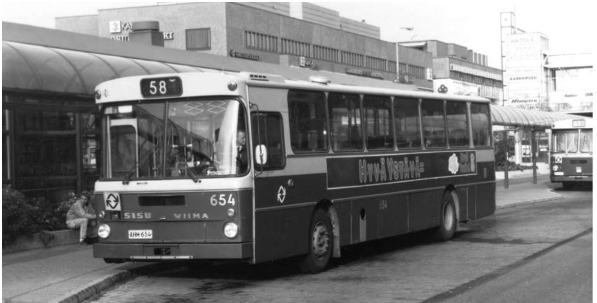
Helsingin kaupungin liikennelaitos 654, Sisu BT-69BVT / 5900 / Wiima K100-220 vm. 1976. BVT-Sisuissa moottori oli turboahdettu Leyland O.510. Alustaan vakiintui hidastimella varustettu Voith D851. Kuva Pertti Leinomäki 3.10.1988, Helsinki.
