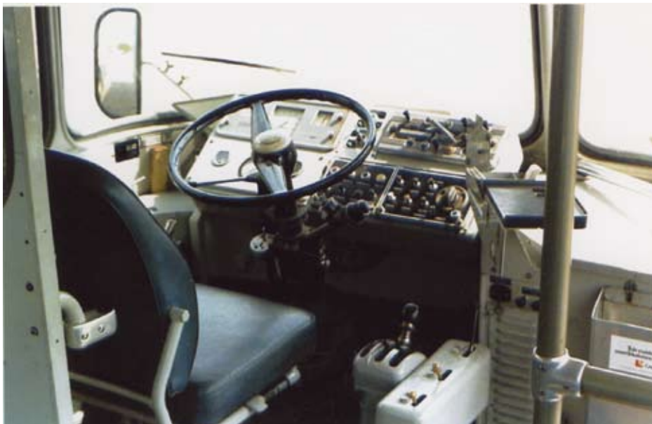
Leylandin HKL 682 ohjaamo hallintalaitteineen. Leylandin alkuperäinen nelipuolainen ohjauspyörä on korvattu Sisun kaksipuolaisella ratilla. Kuva Pertti Leinomäki 26.5.1976, Helsinki.
