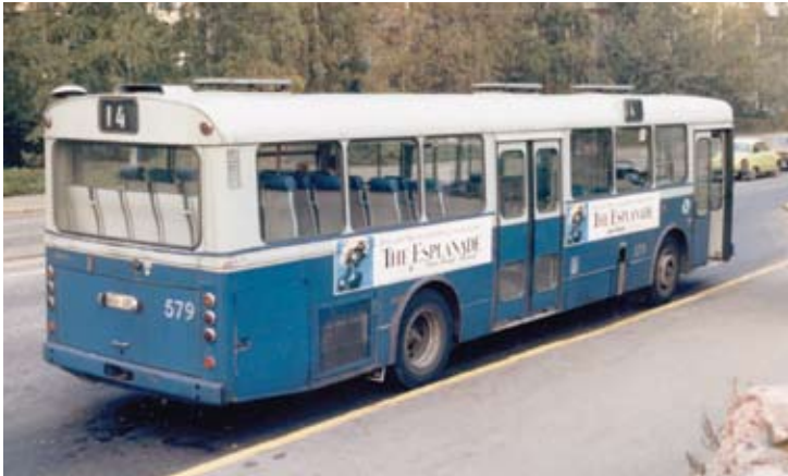
Helsingin kaupungin liikennelaitos 579, Scania BR111M57 / 5700 / Wiima HKL vm. 1975. Autossa keskiovet ovat koemallia. Kuva Pertti Leinomäki 21.9.1982, Helsinki.
