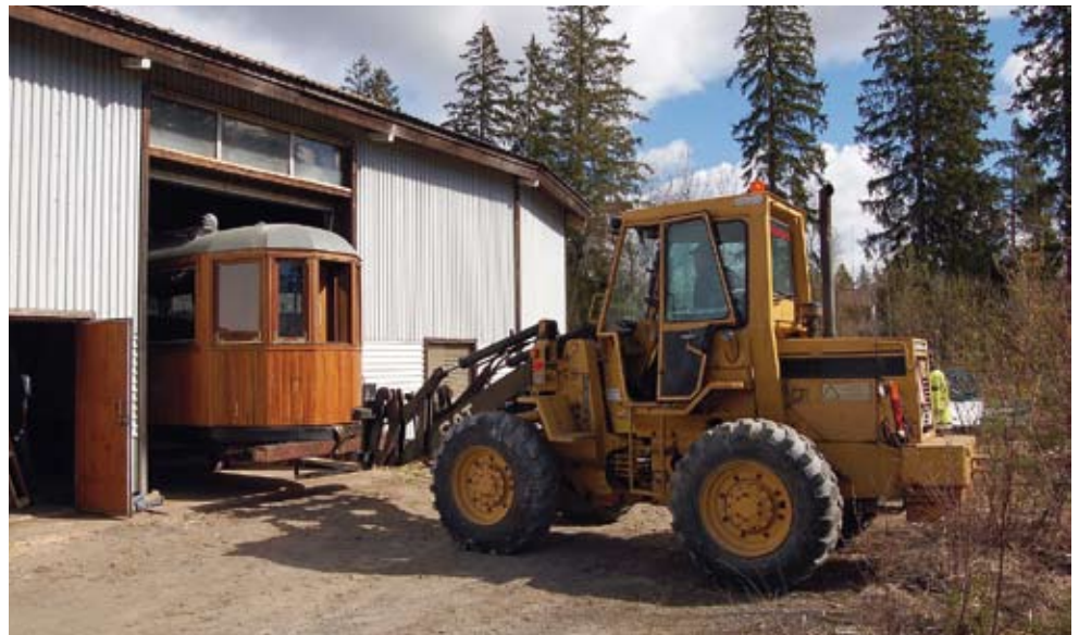
Vaunun siirto Helsinkiin alkoi pyöräkuormaajan avustuksella ja vetämällä se nestetunkkien päällä ulos hallista. Kuva Jorma Rauhala 2.5.2007.
