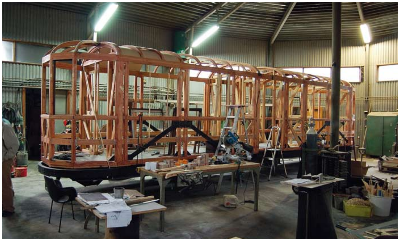
Vaunun kori oli saanut syksyksi "luurankonsa" ja vaunun muoto rupesi hahmottumaan. Kuva Jorma Rauhala 8.9.2006
