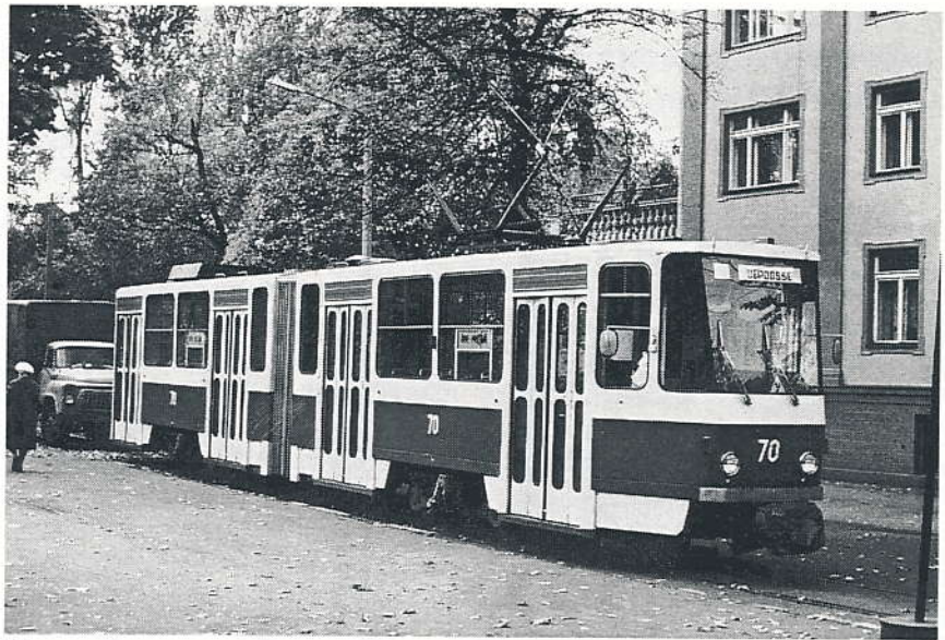
ČKD-Tatran valmistama nivelvaunu nro 70 Kadriorgin pistoraiteella kou- lutusajon tauolla. Vaunussa on hallikilvet eli "Depoose". KT4-SU -vaunu on vain kahdella telillä eli nivelen alla ei ole juoksuteliä. 4.10.1981 (JR)
