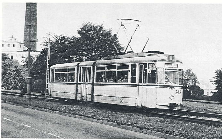
Gothan G4-61 -tyypin nivelvaunu 243 linjalla 1 Mere puisteellä. Vaunutyypin on ns. kaksi-huonetta-ja keittiö -mallia eli kaksinivelisessä vaunussa on lyhyt keskiosa. G4-61 -tyyppiset vaunut ovat periaatteessa yhteenrakennettuja kaksiakselisia moottori- ja perävaunuja perinteisellä jäykällä alustalla eli siis ilman telejä. 4.10.1981 (JR)
