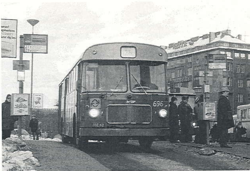
HKL 696, Leyland Royal Tiger Worldmaster 1/1 / Wiima vm. 1965. Kuvanottohetkellä Lauttasaaren silta oli suljettu, niinpä Simonkentältä lähti ko. suuntaan monenlaisia linjoja, kuten 21, 21A, 21T ja 21V.
