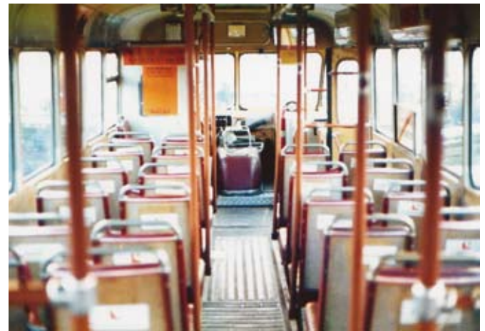
Helsingin kaupungin liikennelaitos 4150 (alkujaan 415), Scania-Vabis B7563 / Wiima vm. 1960 kuljettajarahastusautona Simonkentällä. Taaempi takaovi puuttuu, samoin keskiovi. Kuva Jukka Liehu.
