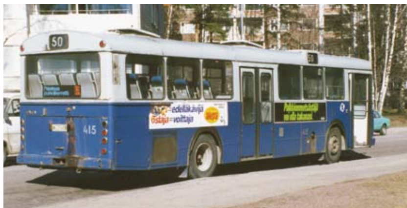
Helsingin kaupungin liikennelaitos 4150 (alkujaan 415), Scania-Vabis B7563 / Wiima vm. 1960 kuljettajarahastusautona Simonkentällä. Taaempi takaovi puuttuu, samoin keskiovi. Kuva Jukka Liehu.
