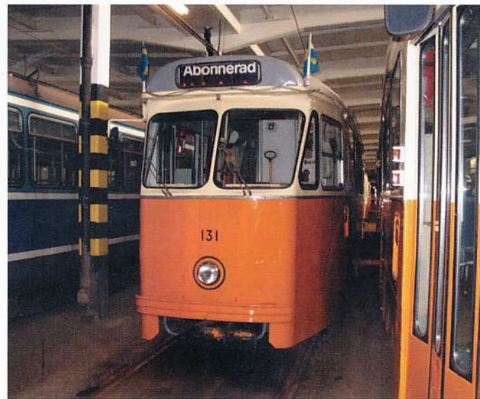
M67 nro 131 eli teatterivaunu. Ulkoisesti 131 vastaa alkuperäistä M67:ää, tosin otsakilpeä on levennetty. Kuvan oikeassa laidassa näkyy vaunun 92 Scania CR112 –ovia.
