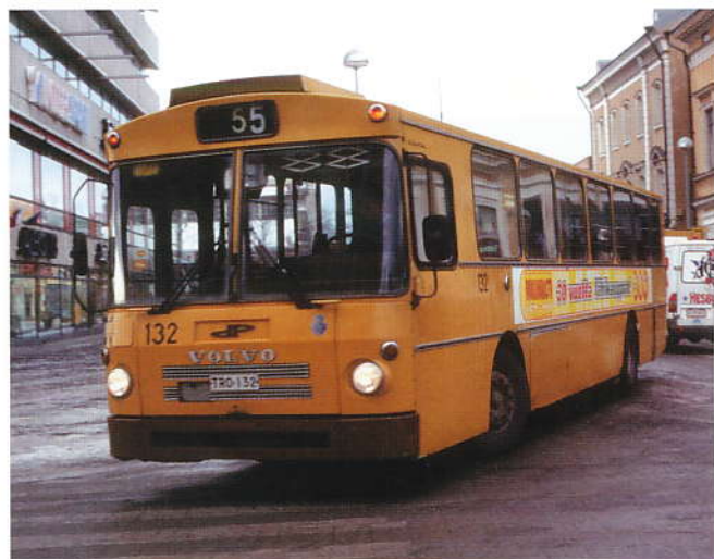
Scanioiden jälkeen TuKL:lle tuli vielä viiden Delta-korisen Volvo B10M:n sarja vuonna 1981. Nämä autot ehtivät vielä palvella uudenkin vuosituhannen puolella. Sisustuksena edelleen punaiset ns. HKL-mallin istuimet ja puunväriset sisäseinät. Alustan vaihteistona oli Allison. Kuva maaliskuulta 2000.
