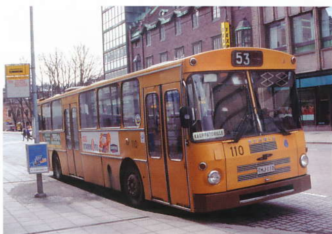
TuKL ajoi osalla Scania BR111M –autoja varsin pitkään, eli vuoteen 1999 asti. Tämä maaliskuussa vuonna 1999 kuvattu auto 110 kuului vuoden 1978 hankintaerään. Tämä erä sekä vuonna 1980 tulleet viimeinen BR111M-sarja olivat koriltaan lähes identtisiä vuoden 1976 autojen kanssa.
