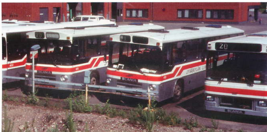
Jyväskylän Liikenteellä oli Scania BR145 –alustaisen auton lisäksi pari hetku-Scania BF111 / Delta Cityä. Autoissa oli Wilson-vaihteisto ja toiseen on myöhemmin vaihdettu teräskuoppien tilalle Wiiman pehmeät penkit. Nämä hetkut olivat vuodelta 1981. Kuva kesäkuulta 1995.
