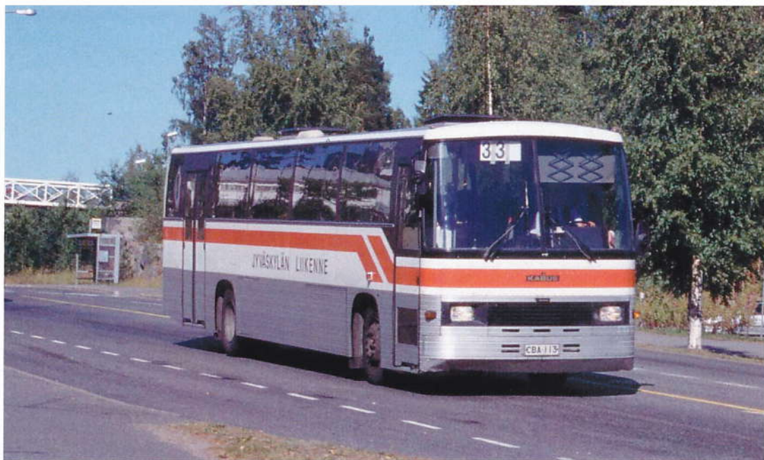
Oy Liikenne Ab 131, Kabus TM-6Z1/680 vuodelta 1995. Talvella 1995–96 Kabus Oy valmisti viiden auton sarjan kaupunkiautoja Oy Liikenne Ab:n tarpeisiin. Moottori on 6,9 litrainen MAN ja vaihteisto ZF. Kuva Teemu Collin syksyllä 1998.
