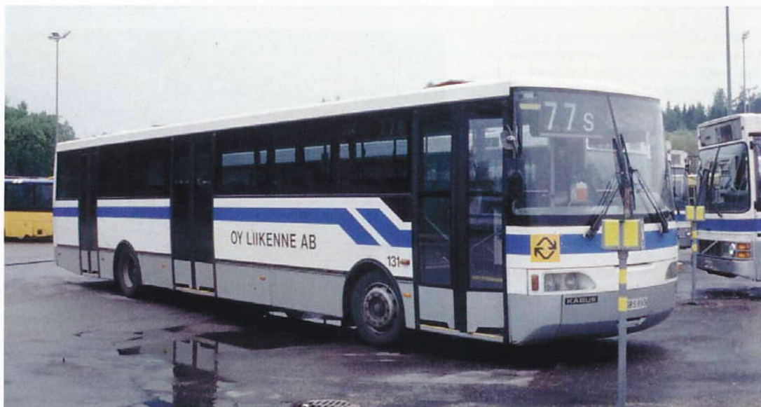
Oy Liikenne Ab 131, Kabus TM-6Z1/680 vuodelta 1995. Talvella 1995–96 Kabus Oy valmisti viiden auton sarjan kaupunkiautoja Oy Liikenne Ab:n tarpeisiin. Moottori on 6,9 litrainen MAN ja vaihteisto ZF. Kuva Teemu Collin syksyllä 1998.
