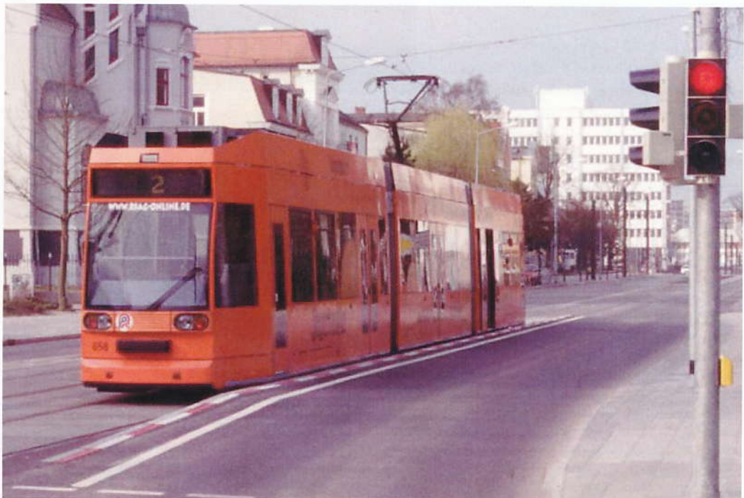
Eräs tapa tehdä kadun keskellä kulkevalle raitiotie- radalle matalalattiavaununukel- poinen pysäkki. Korkeatasoi- nen ja tilava pysäkkikatos sijaitsee jalkakäytävällä. Katoksen ja radan välinen autokaista on korotettu pysäkin kohdalla vaunun lattiatasoon ja ajoradan ylitys turvataan liikennevaloin. Vaunun saapuessa pysäkillä, autoliikenne pysäytetään automaattisesti punaisiin liikennevaloihin ja vaunuun siirtyminen on siten helppoa ja turvallista. Kuva Jorma Rauhala 19.4.2003.
