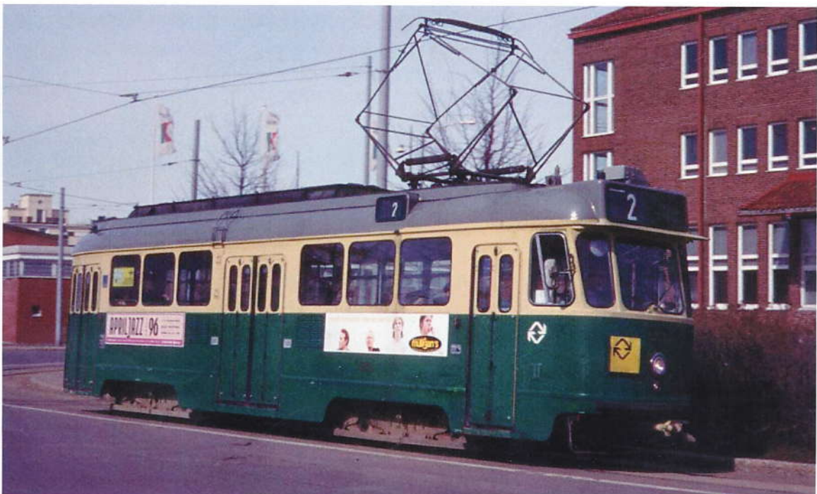
Valmet-vaunu HKL 23 lähestymässä Katajanokan terminaalia. Vaunussa 23 saksisankavirroittin pysyi kesään 1998 saakka. Muista saman sarjan vaunuista saksisanka oli viety jo vuosia aikaisemmin pois. Kuva Juhana Nordlund 15.4.1996.
