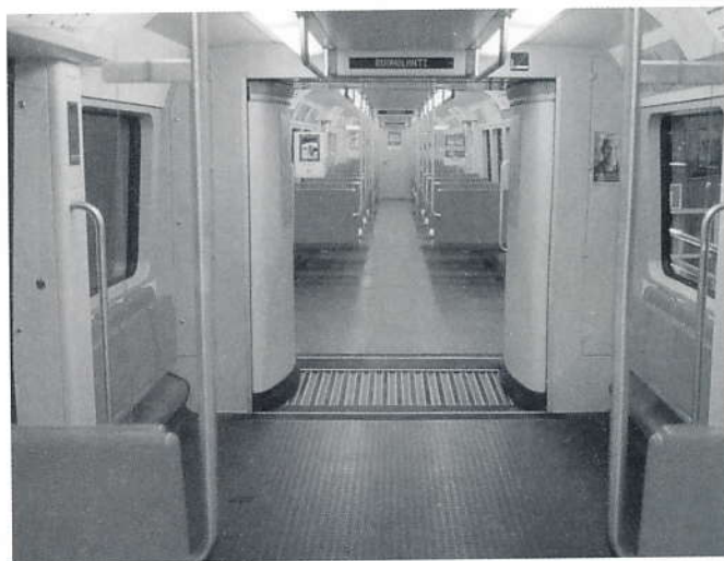
200-sarjan vaunun takapää. Tämä väljä tila on tarkoitettu ensisijaisesti lastenvaunuille, pyörätuoleille ja polkupyörille. Kummallakin sivuseinällä on kolme kääntöistuinta. Vaunun oma numero on merkitty vaunun matkustamon ja ohjaamon väliseen seinään mustin numeroin. Kuva: Mikko Alameri 24.4.2002
