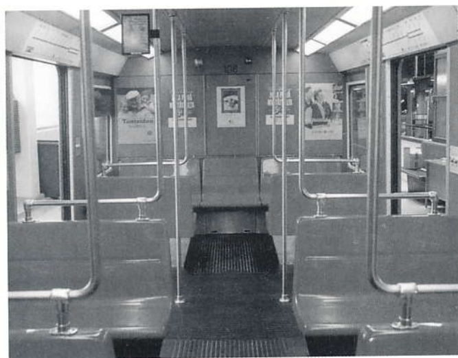
100-sarjan vaunun takapää. Istumajärjestys takaseinän penkeillä on 2+1+2. Häätäpuhelimen yläpuolelle on nykyään merkitty vaunun numero suurilla mustilla numeroilla. Kuva: Mikko Alameri 24.4.2002
