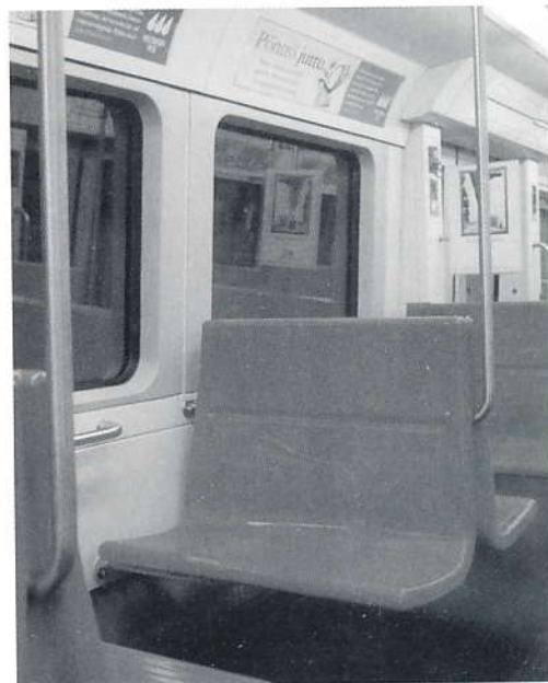
200-sarjan vaunun takapää. Tämä väljä tila on tarkoitettu ensisijaisesti lastenvaunuille, pyörätuoleille ja polkupyörille. Kummallakin sivuseinällä on kolme kääntöistuinta. Vaunun oma numero on merkitty vaunun matkustamon ja ohjaamon väliseen seinään mustin numeroin. Kuva: Mikko Alameri 24.4.2002
