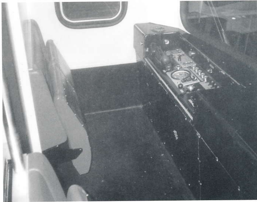
M3:n ohjaamo vuonna 2002. Koska Helsingin metroa suunniteltiin automaattiajoon, ei ohjaamon toteutus ollut kovin ergonominen. Paikkahan oli tarkoitettu vain "käsinajoon" varikkoalueella tai poikkeustapauksissa matkustajaliikenteessä.
