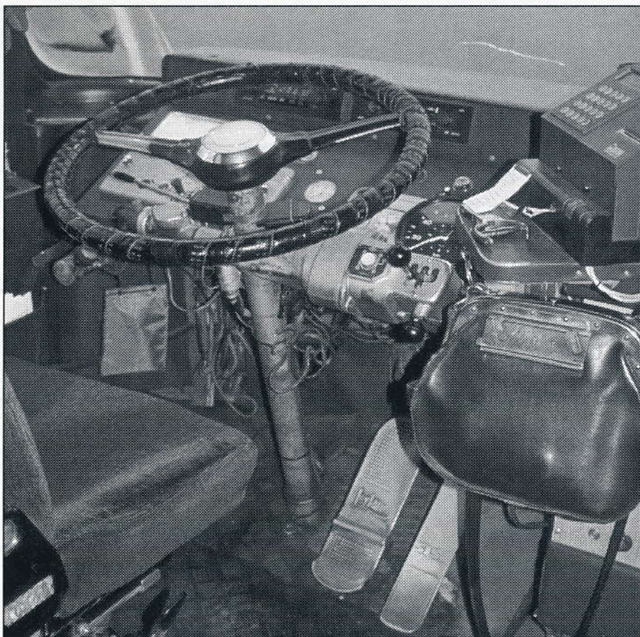
Luopioisten Linja Oy:n Leyland PSU 3C-2L:n hallintalaitteet ja kojetaulu. Wilson-puoliautomaattivaihteen valintalaitetta kutsuttiin useasti nimellä "nappula". Kuva Teemu Collin, 2000
