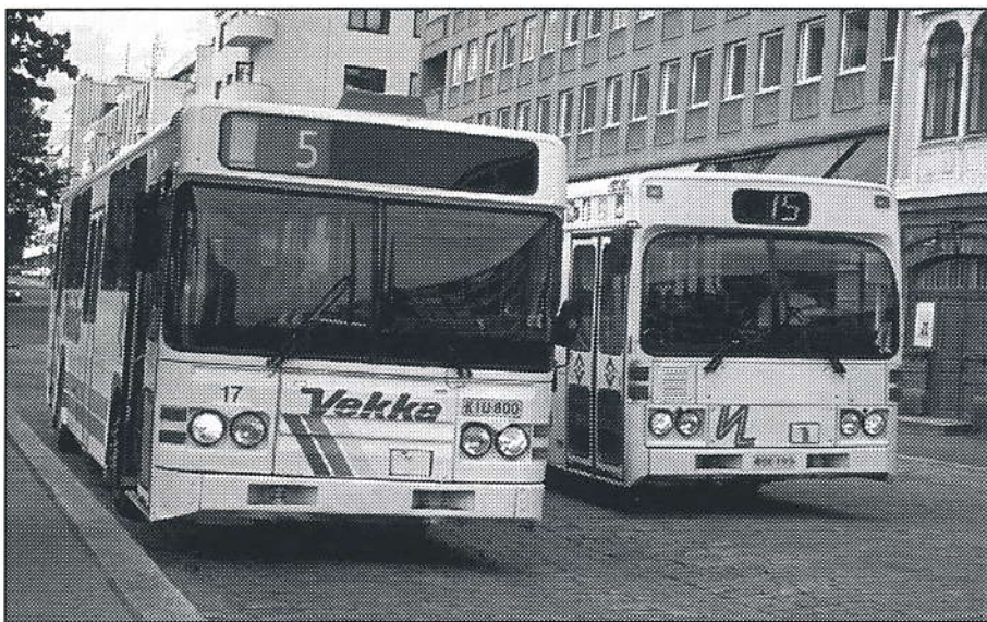
VEKKA LIIKENTEEN BUSSIT 17 JA 15 HÄMEENLINNASSA PALOKUNNANKADULLA. AUTO 17 HANKITTIIN HÄMEENLINNAN SYKSYLLÄ 1999. AUTO ON ENTINEN GÖTEBORGS SPÄRVÄGAR B42 NRO 34. AUTO ON VALMISTUNUT KEVÄÄLLÄ 1986 (SCANIA CN112CL). VAHTEISTO ON NELIPORTAINEN SCANIA-AUTOMAATTI GAV770R. KUVA JUHANA NORDLUND 27.6.2000, HÄMEENLINNAN
