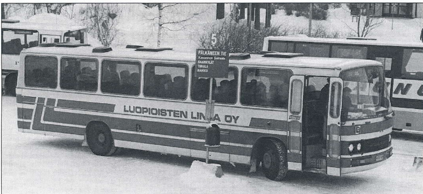
LEYLAND LEOPARD PSU-3C/2L ALUSTALLA JA KUTTER 9 8NDASH; KORILLA VARUSTETTU LUOPIOISTEN LINJA OY:N NUMERO 9 ON JUURI TULLUT TAMPEREELTA JATKAAKSEEN PÄLKÄNEEN KAUTTA LUOPIOISTEN KYYNÄRÖÖN. OVET OVAT ERITTÄIN ASIANMUKAISET JA KOMEUDEN KRUUNAA PUOLI-AUTOMAATTIVAIHTEISTO. KUVA KIMMO PYRHÖNEN, KANGASALA 5.3.1998.
