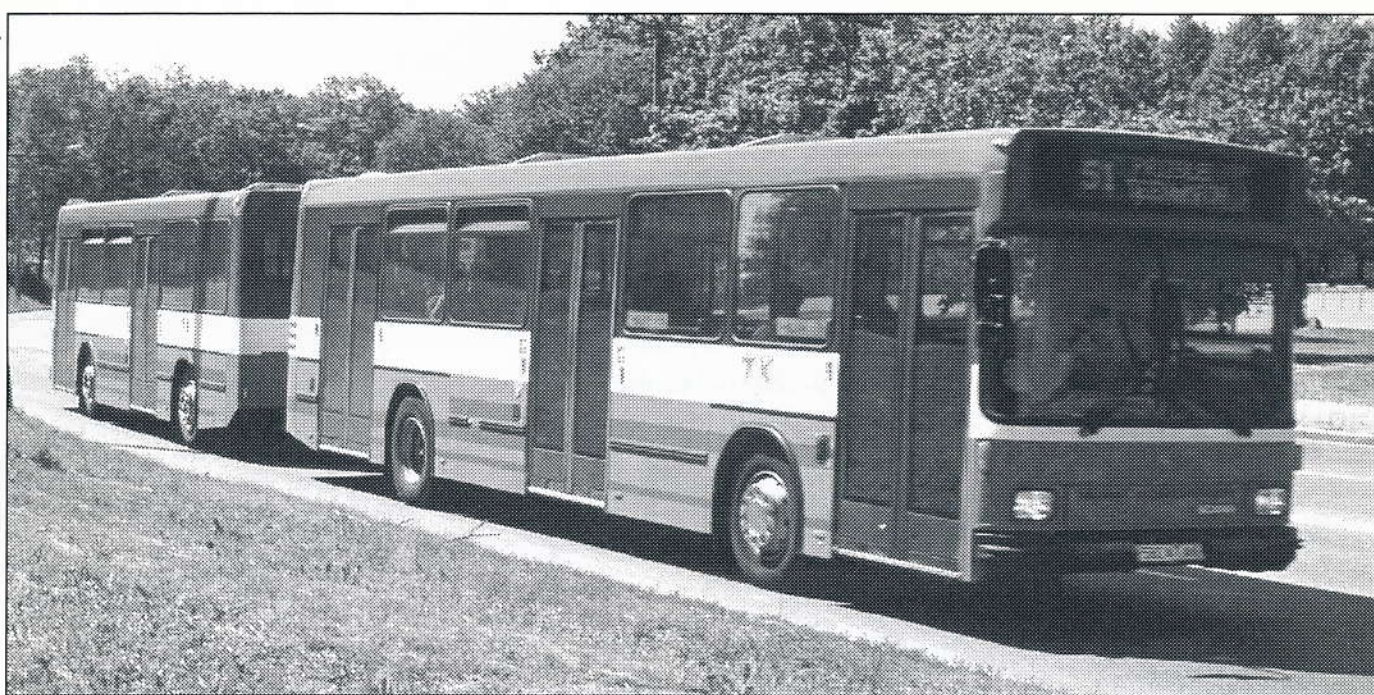
TALLINNASSA LINJA-AUTOJEN KAPASITEETITÄ ON RYHDYTTY NOSTAMAAN VARSIN YKSINKERTAISELLA TAVALLA, LINJA-AUTON PERÄÄN ON KYTKETTY HENKILÖLIIKENTEESÄ SOPIVA PERÄVAUNU. VETOVAUNUNA ON SCANIA L94UB. SUOMEN LAINSÄÄDÄTÖ EI SALLI VASTAAVAA RATKAISUA TÄNNE, HENKILÖKULJETUS PERÄVAUNUSSA TEILLÄMME JA KADUILLAMME ON KIELLETTY. LINJA-AUTOJEN MAHDOLLISUUTTA VETÄÄ PERÄVAUNUA YLIPÄÄNSÄ ON RAJOITETTU SITEN, ETTÄ SALLITTUA ON VAIN HINATA YKSIKSELISTÄ TAI VASTAAVALLA TELIAKSELISTOLLA VARUSTETTUA PERÄVAUNUA. KUVA TEEMU COLLIN 23.6.2000
