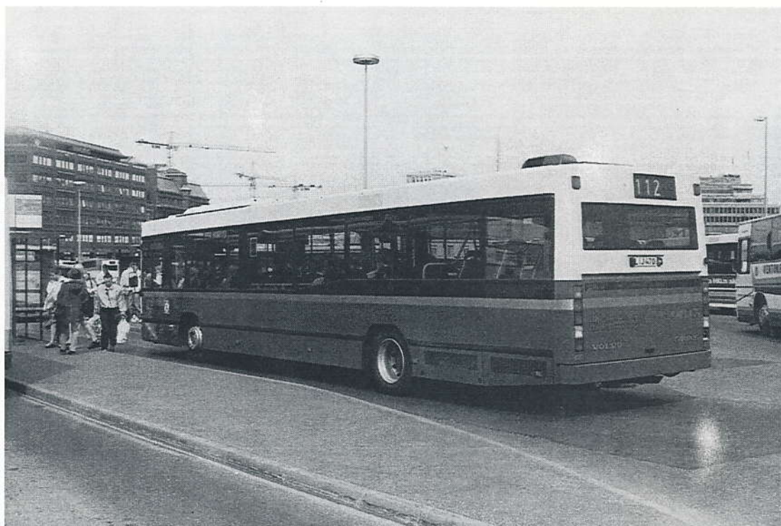
Maakaasukäyttöinen HKL 9815 seutulinjalla 112 (Kamppi - Haukilahti). Auto on tyyppiä Volvo B10L-63 CNG/Carrus City U. Moottorin tyyppi- merkintä on GH10A245, vaihteisto on ZF 5HP 590. Kuva Pertti Leinomäki 19.5.1998.
