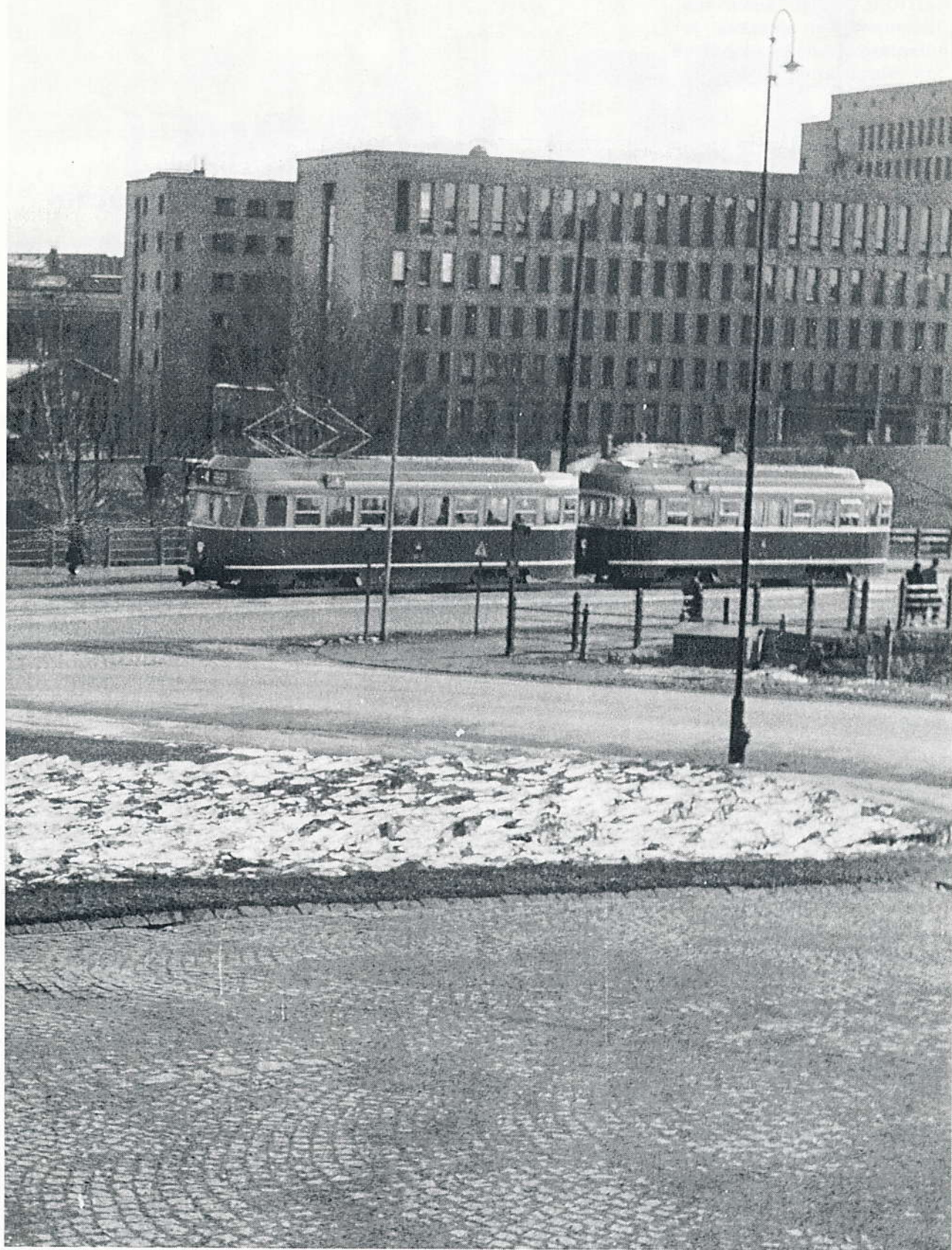
Eduskuntatalon edustalla neloslinjan multippeliajossa oleva vuoro menossa vuonna 1956 Munkkiniemeä kohti. Johtavan RM1-vaunun virroitin on ylhäällä. Perässä oleva kulkee saksisanka alhaalla ikäänkuin perävaununa, mutta kuitenkin moottorivaununa moottorit töitä tehden. Tähän aikaan ei vielä ollut näihin moottorivaunuihin sopivia teliperävaunuja olemassa.
